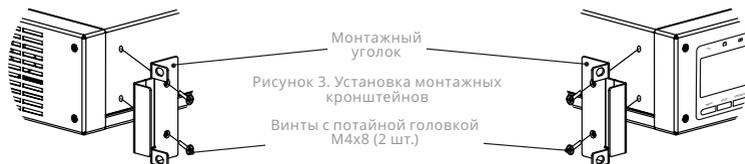
Рисунок 3.1 Установка монтажных уголков
